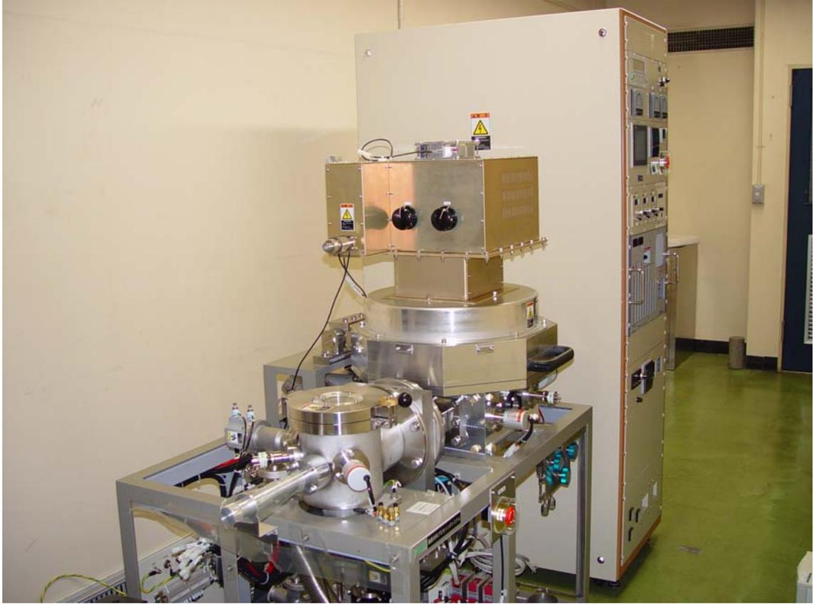
図3 薄膜材料プロセッシングシステム（有機金属原料化学的気相堆積装置）
